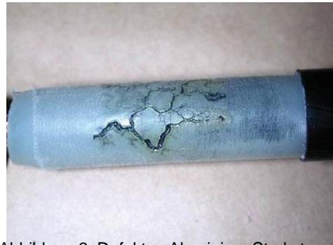
(Abbildung 2: Defektes Aluminium Starkstromkabel)
