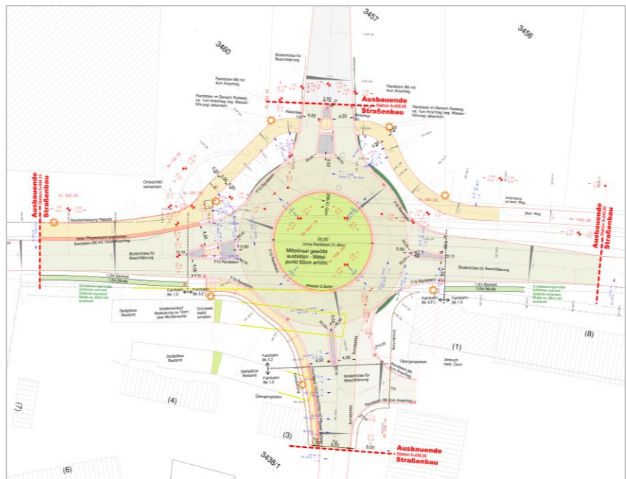
Abbildung 7: Vorentwurf Kreisverkehr Balingen L 415 – Auf Jauchen (Ohnmacht In- genieure, 17.04.2020)
