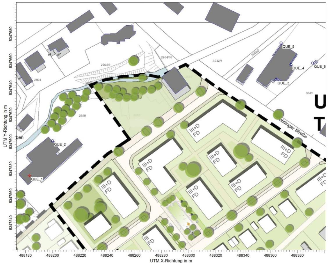
Abbildung 6. Darstellung der Quellen im Modell (Punktquelle rot, Volumenquellen blau) mit modellierten Gebäuden (grau).
